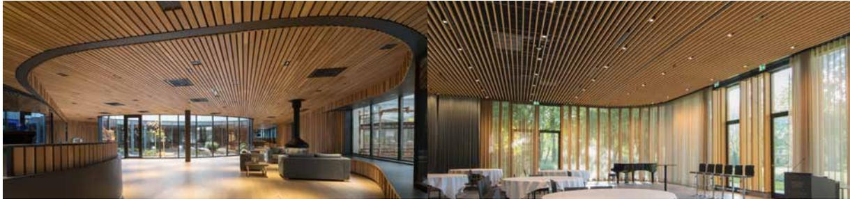
Das DERA KO-Deckensystem ist in zwei Hauptsystemen erhältlich. Bei dem linearen System werden die Holzteile bündig in das System eingearbeitet. Das Rastersystem verleiht Ihrer Decke zusätzliche Tiefe.
